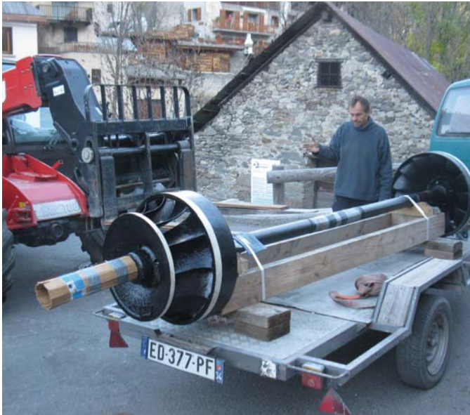
Transport der revidierten Turbine
